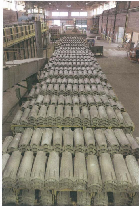
↑ Tuiles canal « vertes » avant cuisson, empilées dans l'usine de Castelnaudary.
