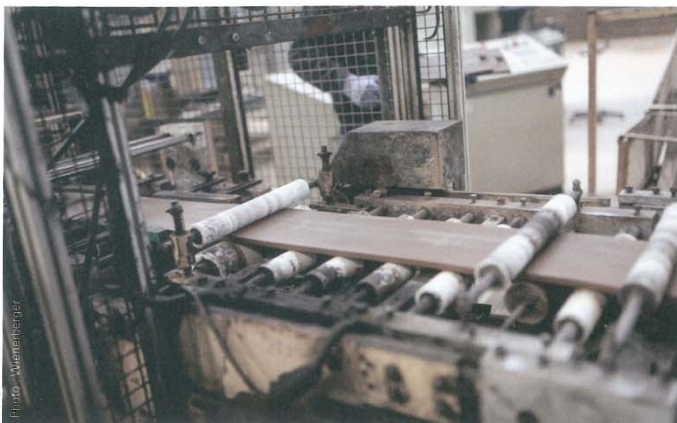
↑ Tuiles Aléonard réalisées selon une méthode traditionnelle : l'argile défile sur la filière, puis est découpée en tronçons avant cuisson.
