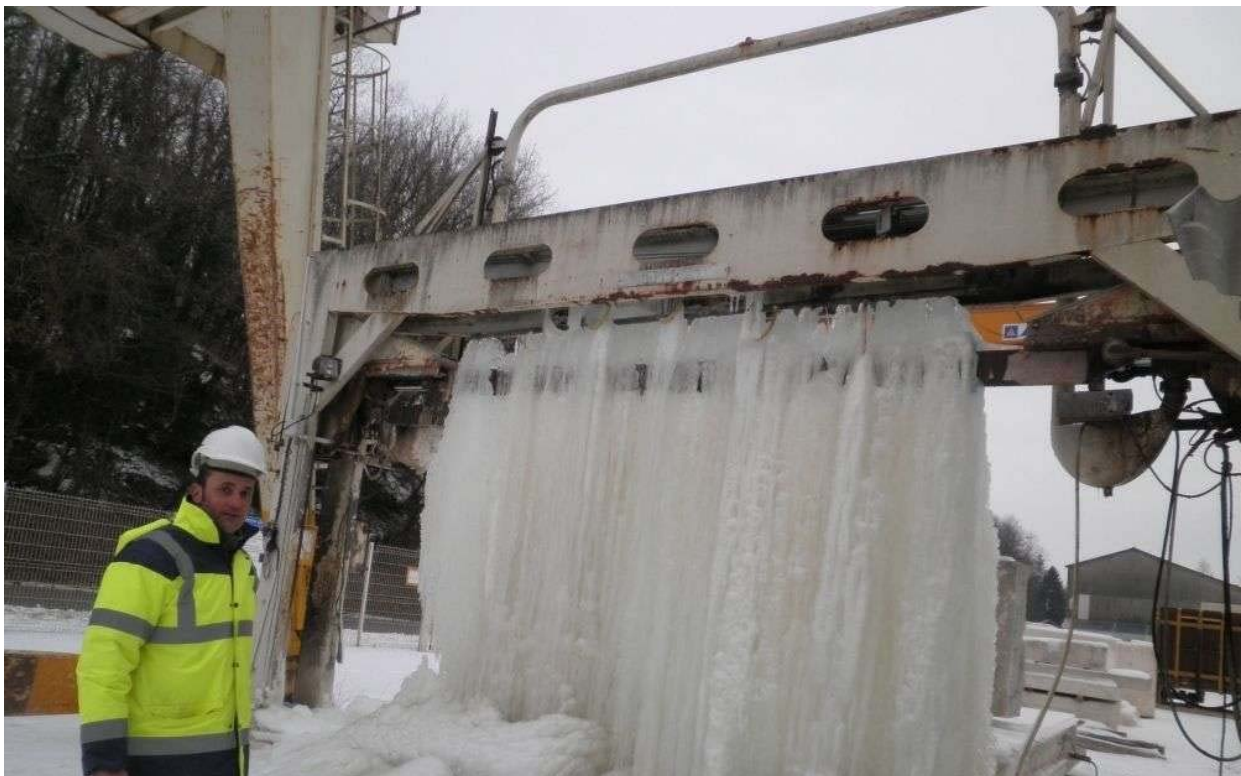
Christophe Ferré, le responsable du site de Vilhonneur, devant la monolame prise par les glaces qui ne peut plus trancher les blocs de pierre. Photo S. C.
