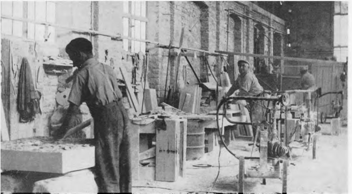
Quelques-uns des appareils à flexibles, les uns suspendus, les autres sur chariot.
