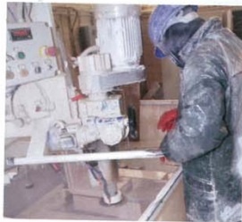
Au niveau du sciage secondaire, l'usine de Saint-Maximin possède cinq débêteuses Décamps, dont une de 2 m, deux de 1,5 m et deux de 0,7 m de Ø. Elle est équipée également d'un polissoir à chant LCV Marmo Meccanica.
