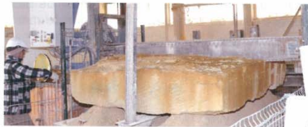
Le sciage primaire s’effectue à l’aide d’un monofil Bideseimpianti (Bretor), un monolame BM ou un châssis multilame Décamps. Les petits blocs sont quant à eux sciés à l’aide de trois guillottes Rexo.
