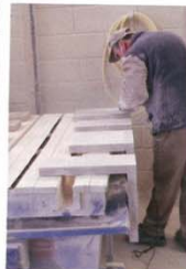
L'entreprise a réouvert une unité de taille de pierre manuelle dans laquelle œuvrent trois personnes. Elle est équipée notamment d'un multifonction manuel Sandra, d'un banc aspirant Ghines et d'une cabine d'aspiration des poussières Italmecc
