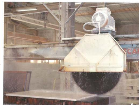
L’atelier est équipé d’une ligne de polissage à plusieurs têtes Gregori, d’une débiteuse automatique Canigo à double tête de sciage disposant de cinq tables de travail.
