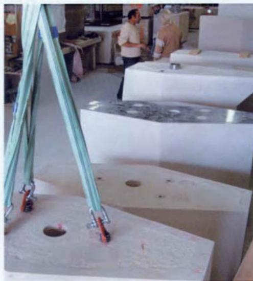
►▲ Les pièces finies, avec quelques éléments spéciaux, stockées dans l'atelier à Buxy. Les 754 éléments nécessaires aux 64 colonnes, représenteront au final 511 m<sup>3</sup> de pierre de Lens.
