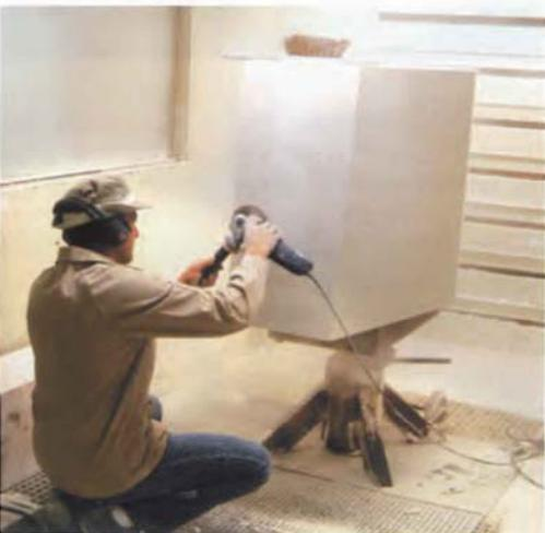
► Finition des éléments à la main dans une cabine à aspiration de poussières et contrôle de l'appareillage des éléments deux par deux.
