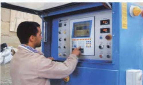
► Programmation de la machine à fil Bideseimpianti spécialement achetée pour ce chantier. Une trentaine de programmes au total sont nécessaires à la fabrication de tous les éléments constitutifs des colonnes. La machine travaille ensuite en automatique avec rotation de la table de travail. A noter qu'après une coupe, le fil remonte sans tourner pour éviter qu'il ne vienne endommager la face sciée.
