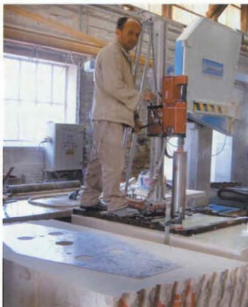
▲ Traçage du gabarit sur le bloc et perçage du trou de précontrainte, à l'aide d'une carotreuse spécialement adaptée.
