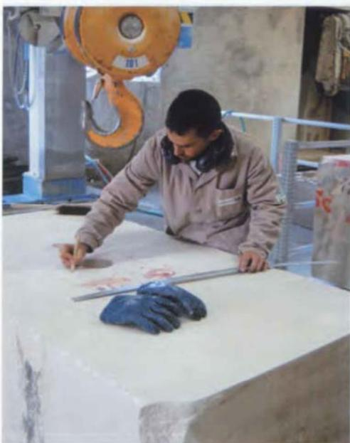
▲► Traçage de l'axe à partir duquel sont programmées les coupes au fil. Les blocs sont pris grâce à des chevilles de levage et amenés sous la machine à fil.
