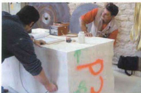
▲ Mesure de la vitesse de son sur les blocs avant façonnage.
