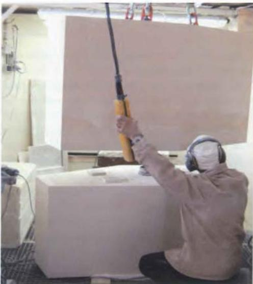
profilage à câble diamanté, programmée, dont l'usine de Buxy s'est dotée spécialement pour ce chantier. La mise en place du bloc sous le fil est très précise, en alignant le câble sur l'axe de la pièce déjà tracé.
