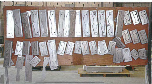
De nombreux gabarits de contrôle des profils ont été réalisés.
