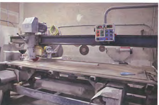
En terme d'équipements, l'entreprise dispose de deux débiteuses Denver, d'une genouillère et d'une potence pour leur alimentation.
